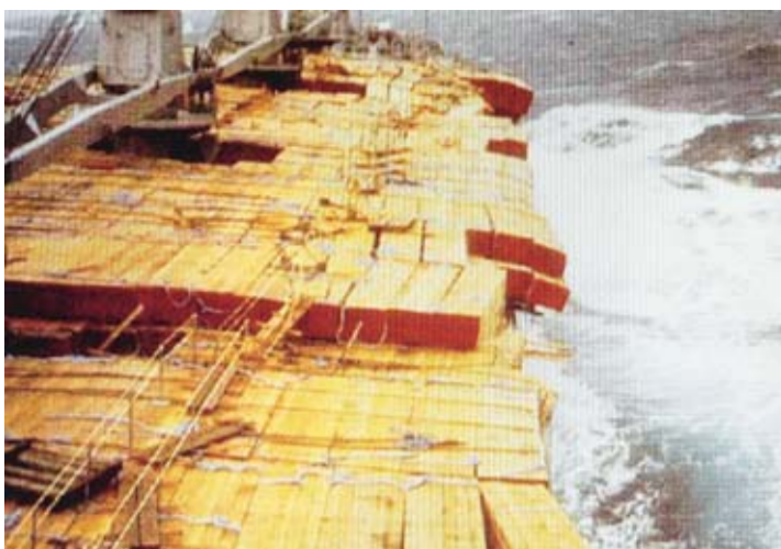
DÅLIGT LASTAD Så här illa kan det gå när timret lastas fel. Bilden är hämtad ur en rapport.
