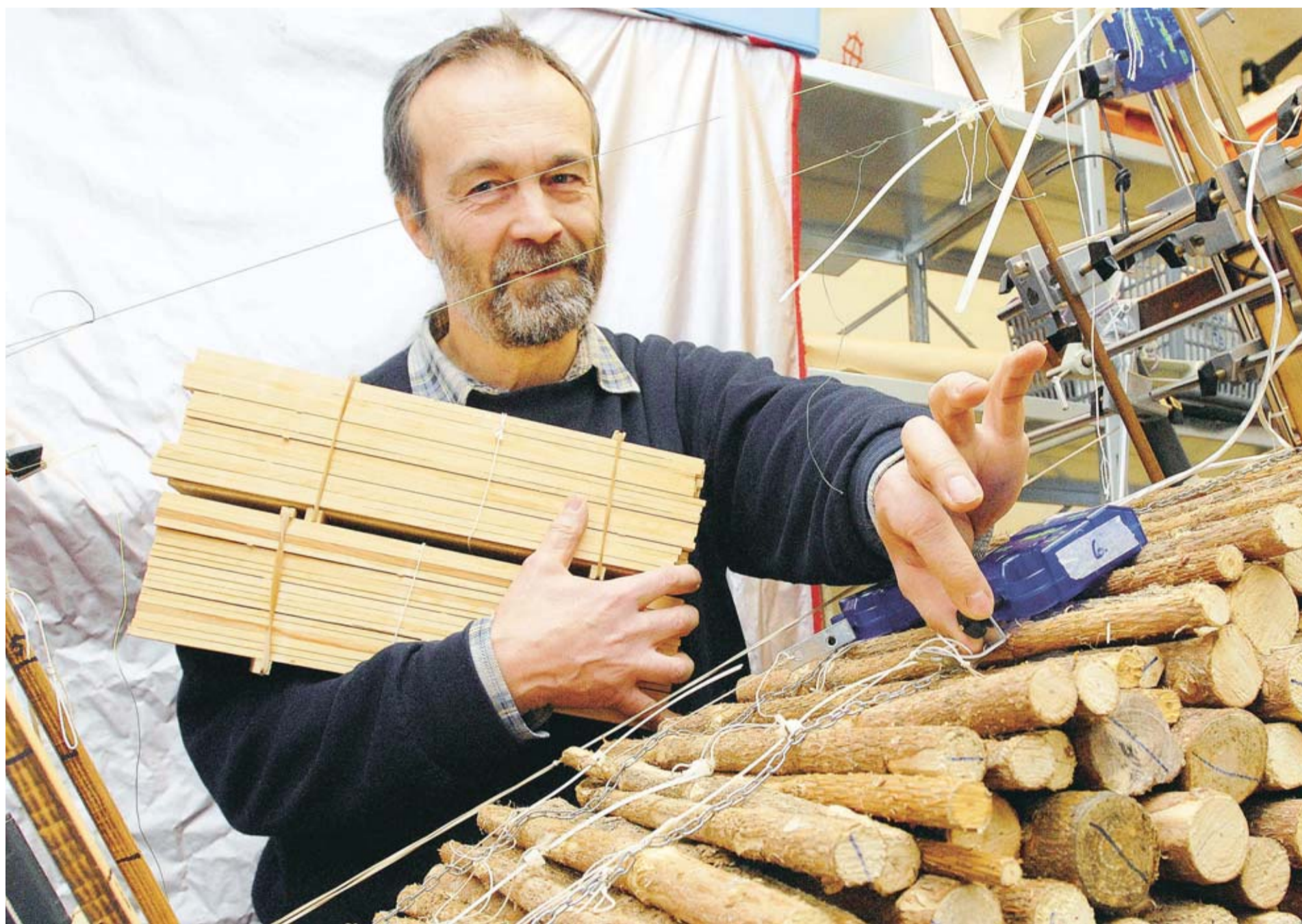
MÅNGA TESTER Överläraren Philippe Chanfreau har tagit fram formler för dimensionering av laststöttor på fartyg. Här visar han sin miniatyrmodell av en timmerlast.
